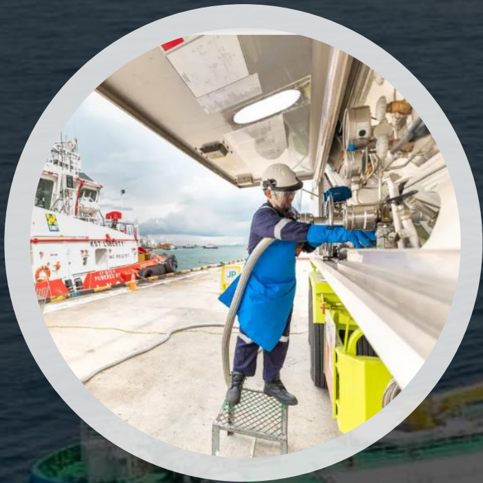
Truck to Ship (TTS) LNG Bunkering
