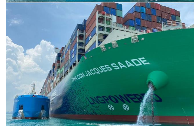
Cool Down and LNG Bunkering of World's Largest LNG fuelled Container vessel
